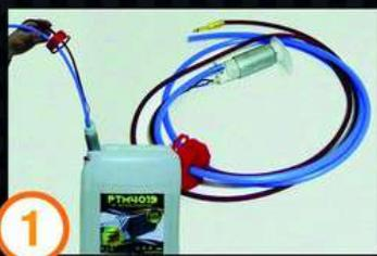
1 Installer le moteur de charge du liquide dans la bouteille de liquide de nettoyage.
