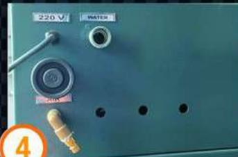
4 L'installation est terminée après avoir installé le tuyau d'air sur l'entrée d'air derrière la machine et connecté la prise de la machine.
