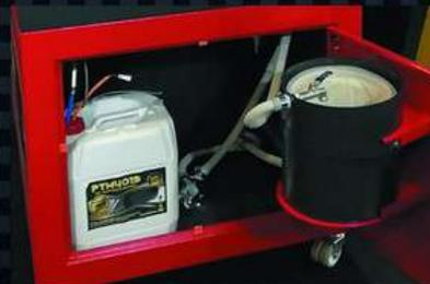
Nettoyage du filtre à liquide et les sédiments
