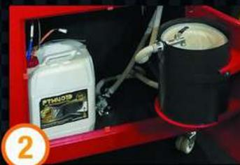
2 Placez le récipient au fond du machine et assemblez le tuyau et le câble sortir du conteneur pour entrée du liquide de nettoyage e Entrée 12V.
